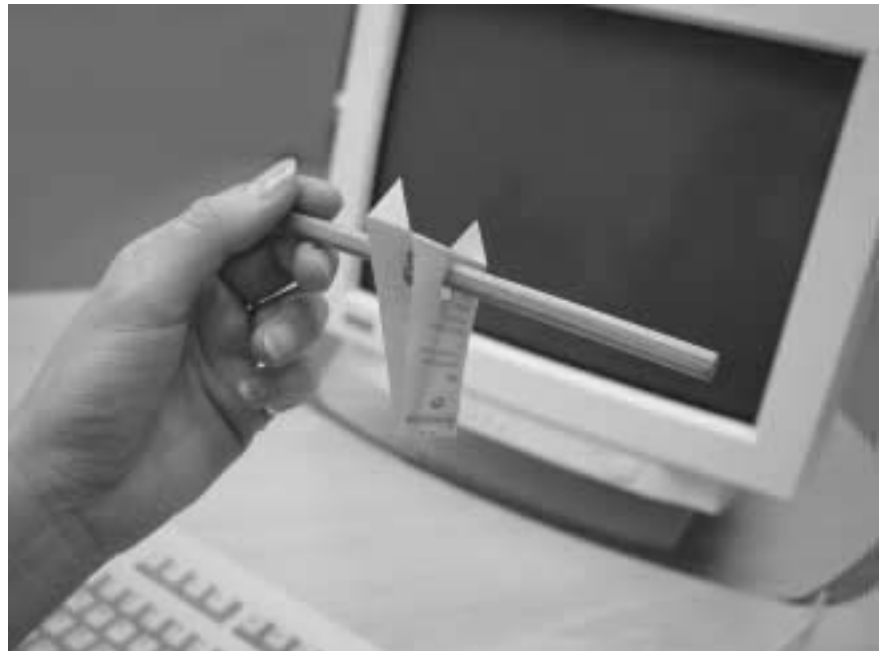
Abb. 29 Mit dem Schwinkeltest kann der Winkel des Sehstrahls vom Benutzer zur Bildschirmitte überprüft werden (Forderung nach DIN EN 35 °)
