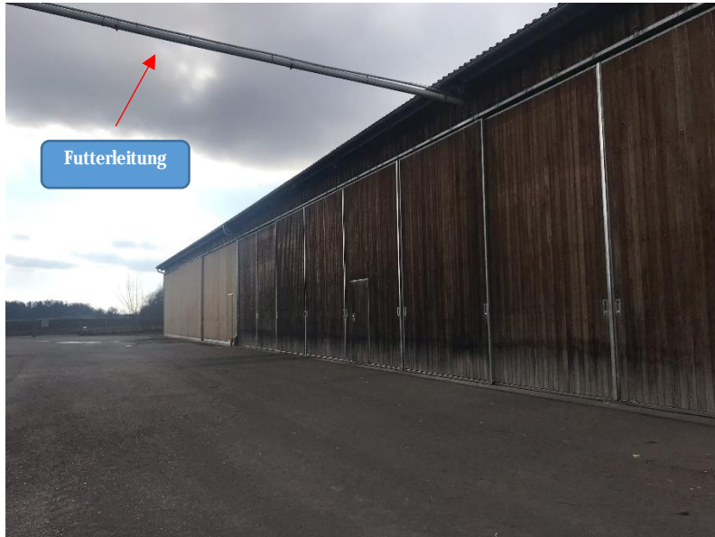
Bild 33: Scheune für die Lagerung mit ausreichender Kapazität für die Lagerung von Stroh für 6 Monate. Auch die Fütterungsanlage befindet sich in der Scheune, Futterleitungen führen oberirdisch in den Tierhaltungs-/Stallbereich
