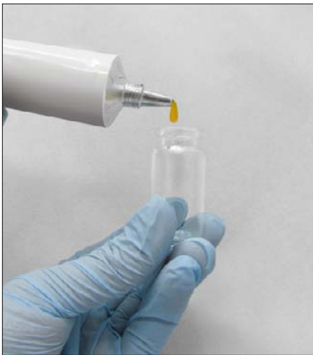
Abbildung 7: Probenvorbereitung zur Untersuchung von Klebstoff
