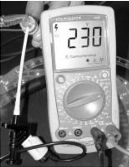
Abb. 15: Spannung führendes Teil an einem Lichterschlauch nach Abziehen der Schutzkappe
