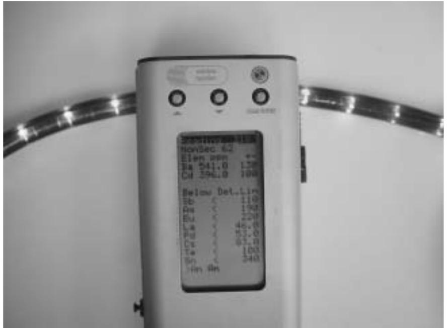
Abb. 11: Bestimmung des Cadmiumgehalts in einem Lichterschlauch mit einem Röntgenfluoreszenzgerät
