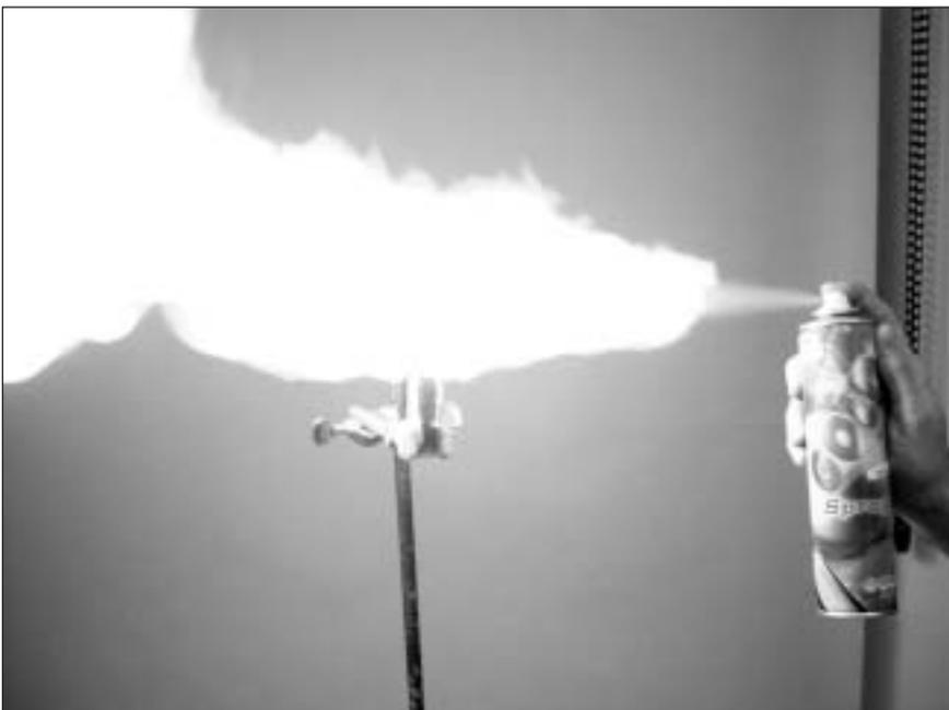
Abb. 12: Flammenwerferartige Entzündung von Dekorationspray an der Versuchseinrichtung mit einer brennenden Kerze
