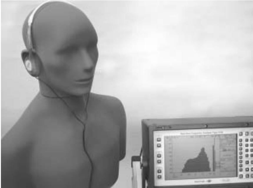
Abb. 26; Kunstkopf zur Messung des gehörnähren Schallpegels von tragbaren Audiogeräten
