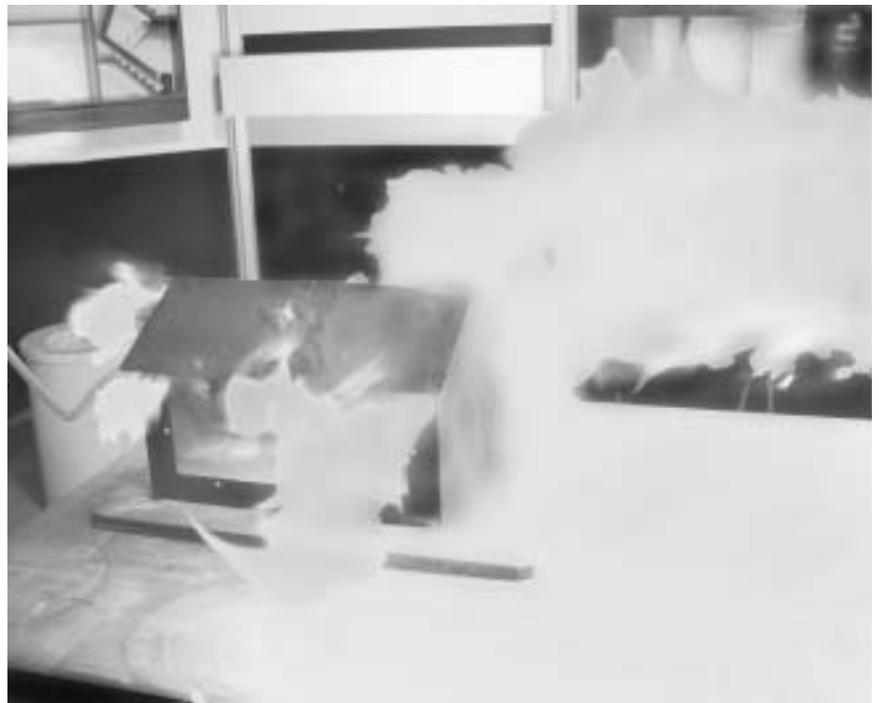
Abb. 13; Modell zum Simulieren einer Staubexplosion
