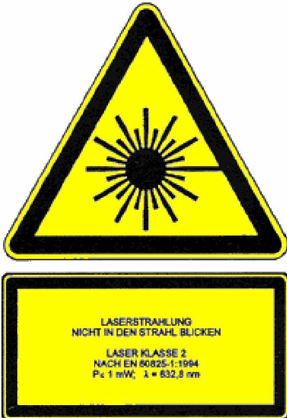
Abb. 2: Kennzeichnung eines Lasers der Klasse 2 nach DIN EN 60825-1
