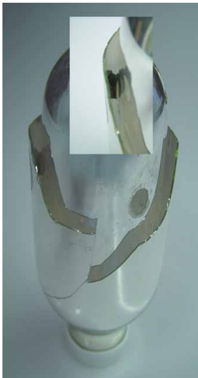
Abbildung 2: Zerstörter Glaskörper einer Thermoskanne; im Bildausschnitt ist der Abstandhalter zu erkennen, der bei der Untersuchung auf Asbest im Vordergrund steht.
