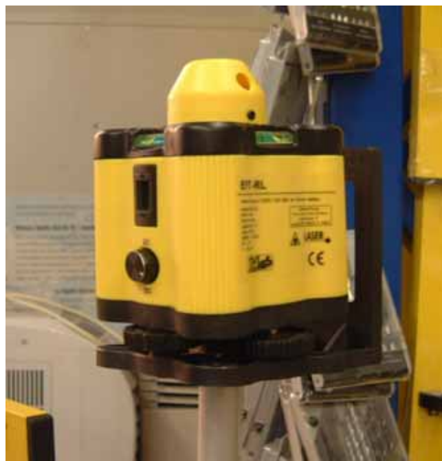
Abb. 5: Nivelliergerät mit Punkt- und Linienlaser
