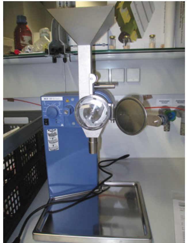
Abbildung 4: Elektrische Mikrofeinmühle mit Mehlkopf zur Probenvorbereitung von biozidhaltigen Waren aus Holz
