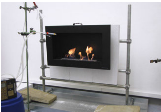
Abbildung 5: Testaufbau für Ethanolöfen
