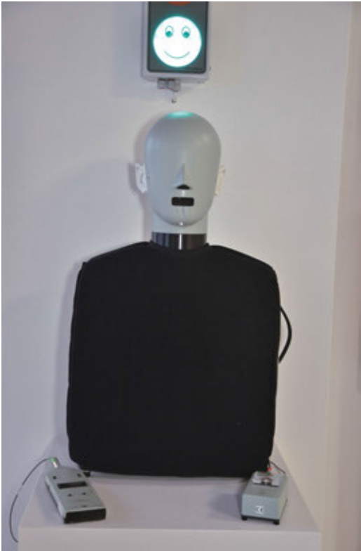
Abbildung 6: Akustikmessgerät in Form eines menschlichen Kopfes mit Ohren aus Kunststoff zur Messung der tatsächlichen Schallbelastung einer Lärmquelle am Ohr (neues Modul „Gehör“)
