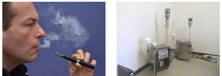
Abbildung 2: In 6 Rauchsitzungen wurden 3 Liquidsorten mit und ohne Nikotin verdampft (links) und parallel dazu die Stäube in der Raumluft gesammelt (rechts).
