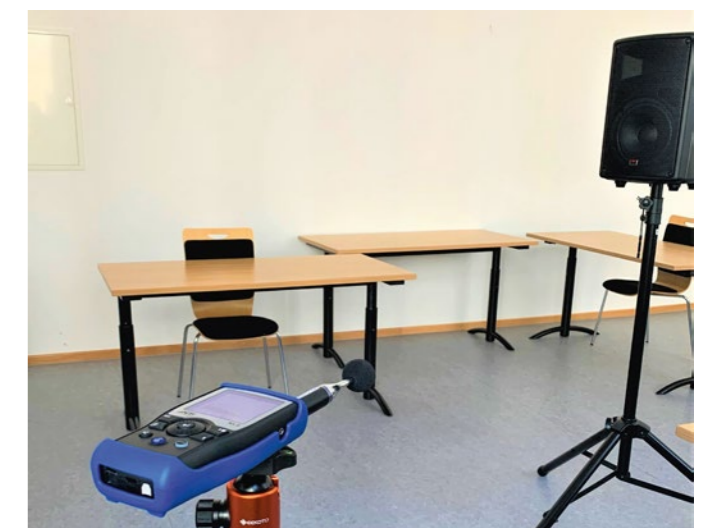
Messung der Nachhallzeit mittels Schallpegelmessers und Lautsprecher
