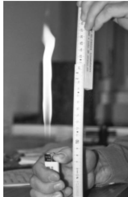
Abb. 18 Messung der Flammenhöhe an dem Einweg-Gasfeuerzeug
