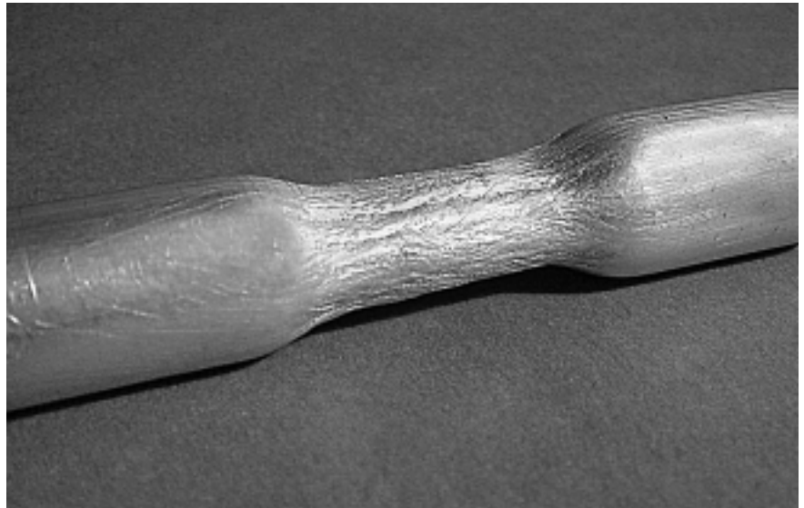
Abb. 20 Werkstückverformung durch stark gepulste Magnetfelder
