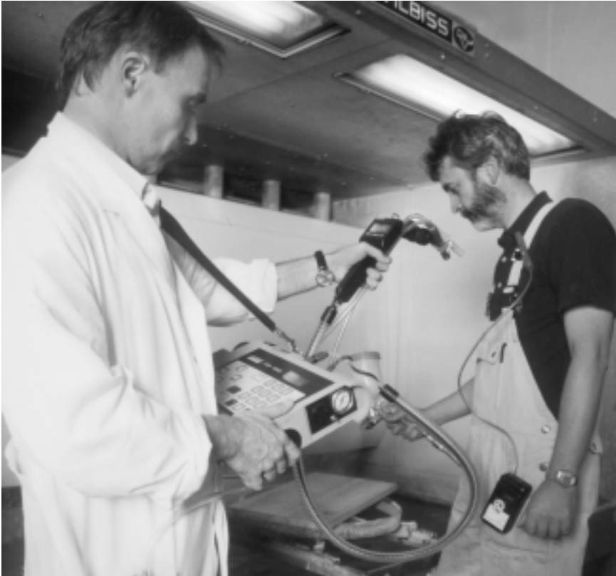
Abb. 11 Arbeitsplatzmessung mit kontinuierlicher Erfassung von gesundheitsschädlichen Dämpfen
