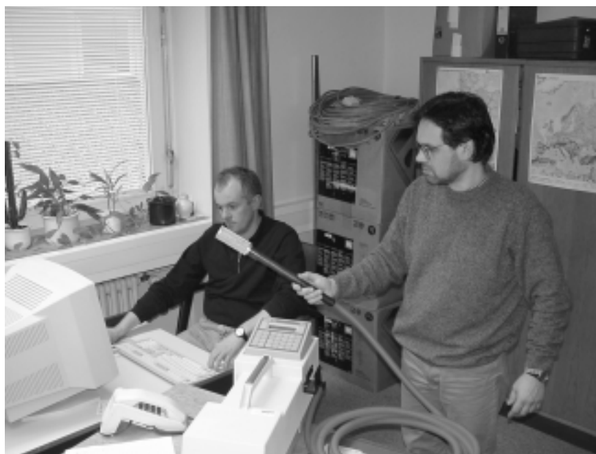
Abb. 21 Messung der Luftwechselrate mit Hilfe des Spurengases \text{SF}_6
