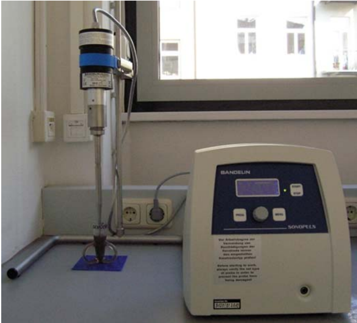
Abbildung 55: Sonotrode zur direkten Ultraschallbehandlung der Proben.
