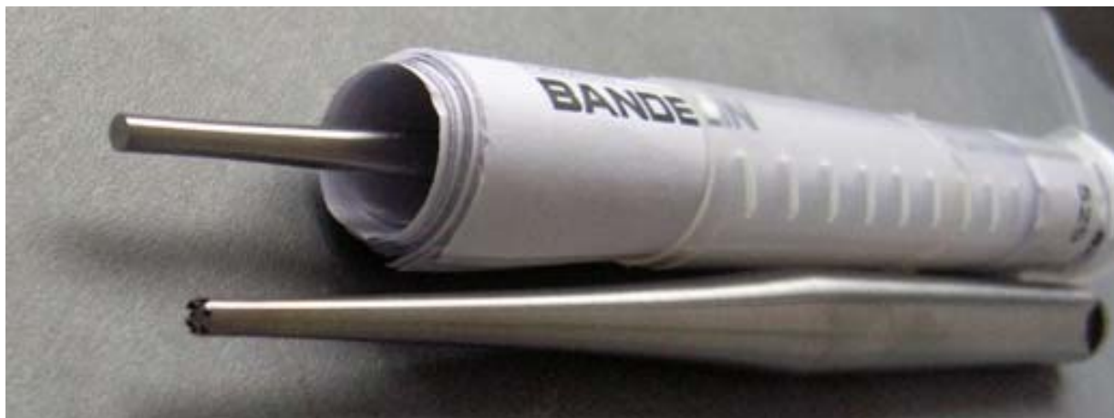
Abbildung 56: Neue (oben) und gebrauchte (unten) Sonotrode. Deutlich zu erkennen sind die Abnutzungen an der Spitze der gebrauchten Sonotrode.
