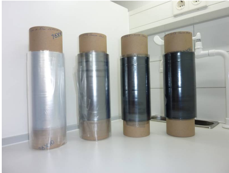
Abbildung 33: LDPE-Flachfolien dotiert mit nanoskaligen TiN (von links nach rechts): Referenzfolie ohne TiN, Folie + 0,01 % TiN, Folie + 0,05 % TiN, Folie + 0,1 % TiN
