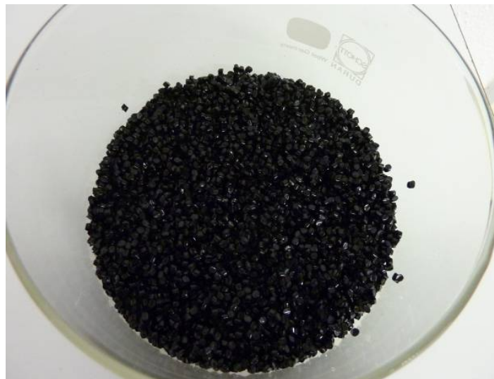
Abbildung 32: Masterbatch-Granulat: nanoskaliges Titannitrid in LDPE
