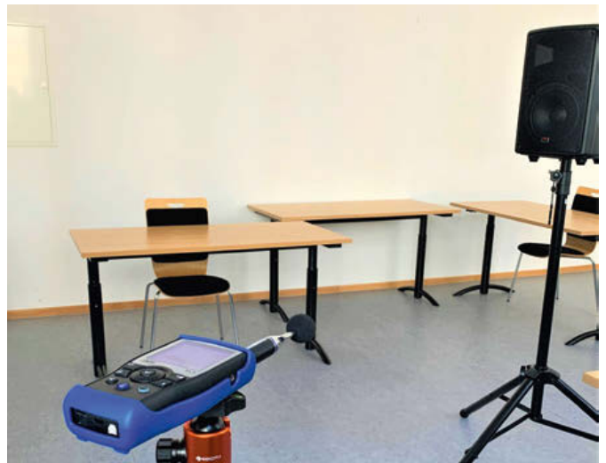
Messung der Nachhallzeit mittels Schallpegelmesser und Lautsprecher
